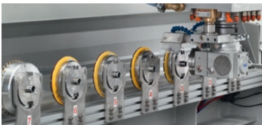
Magazzino dedicato al cambio utensile per aggregato con cambio magnetico.
