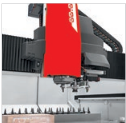
Magazzino a bordo testa rotativo a 8 posizioni per abbattere i tempi di sostituzione degli utensili utilizzati più di frequente.
