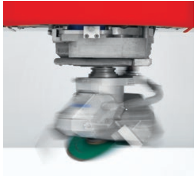
Asse C rotativo infinito per l'esecuzione perfetta delle lavorazioni più complesse in modo fluido e preciso.
